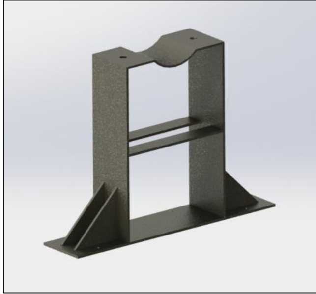
Figura 35 - Apoio do tubo
